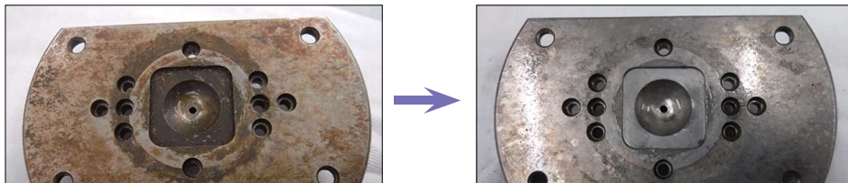
金型洗浄の実施結果 (使用洗浄剤：EL-1、温度：60℃、設定時間：15分)
